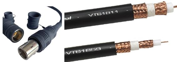
Tous les signaux issus de la caméra sont multiplexés en fréquence et portés par un unique câble coaxial blindé pour résister aux interférences. L'électronique de conversion des signaux est un inconvénient mineur par rapport à la longueur, la souplesse et le prix de revient du câble. En numérique, la version SD est limitée à environ 500 m et la version HD à 200 m.
